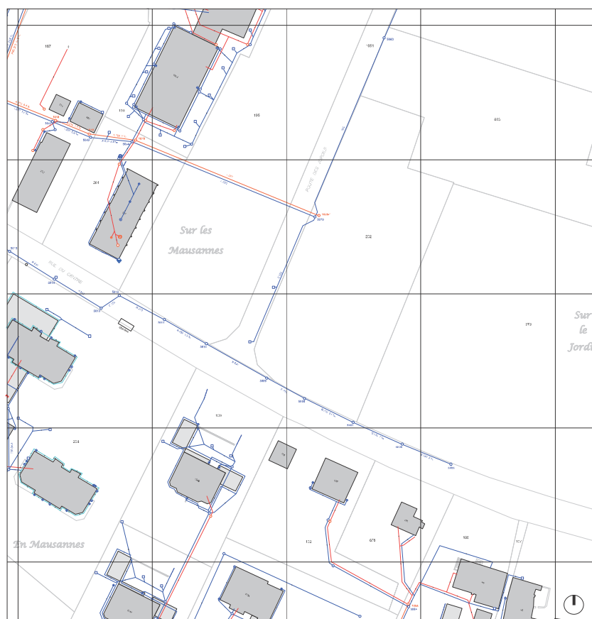
Situation des collecteurs EC (bleu) et EU (rouge) - source : bureau Schopfer et Niggli SA - sans échelle
