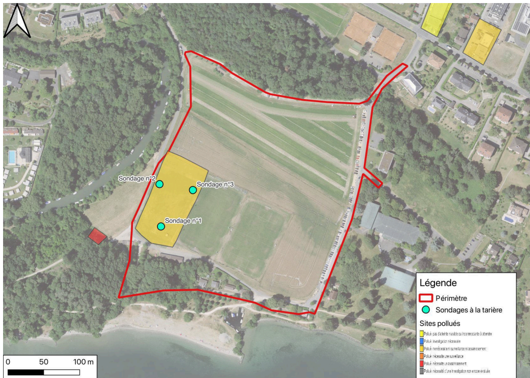
Figure 5-23 Emplacement des sondages à la tarière à l'emplacement du remblai identifié au cadastre des sites pollués.
