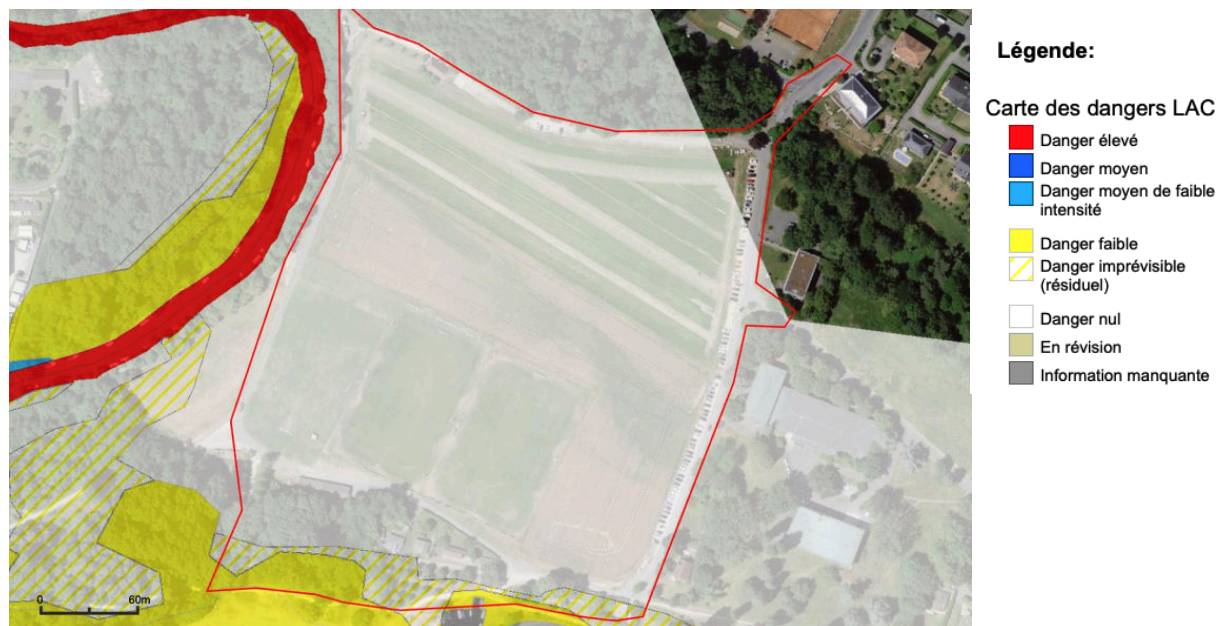
Figure 5-37 Danger d'inondation par remontée du lac
